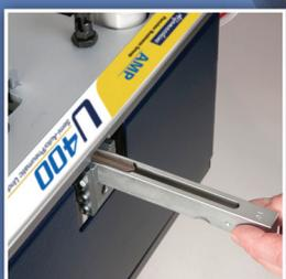
Einfacher Zugang von der Rückseite zum Laden oder Auswechseln der Winkelklammern
